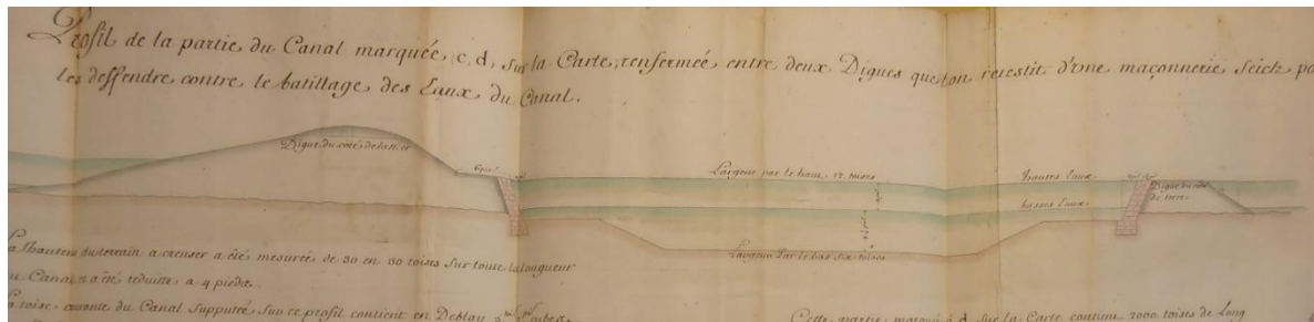
Des profils asymétriques côté mer / côté terre
